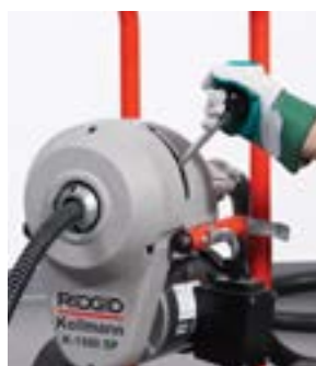
Zatažením páky spojky roztočí spirálu
