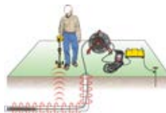
Vyhledání plastových trubek pomocí integrovaného vyhledání vedení.
