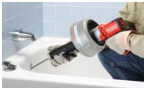
Model K-45AF rychle zprůchodní ucpaná potrubí. Vysouvá a zatahuje spirálu bez zařazování zpětného chodu motoru.
