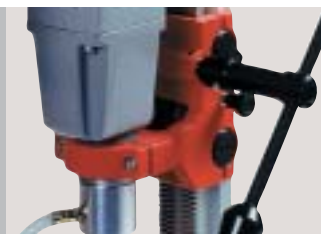
Upevnění vrtačky HC-2(W) na stojanu
