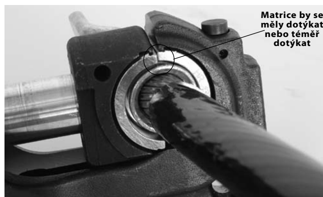
Obrázek 8 – Kontrola matic při aktivaci uvolňovacího tlakového ventilu
