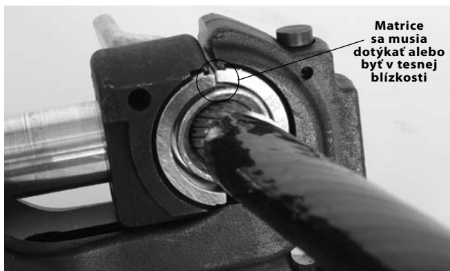
Obrázok 8 – Kontrola matric pri aktivácii tlakového poistného ventilu
