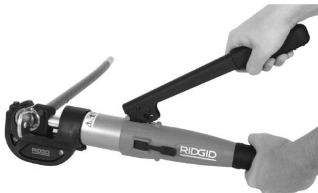
Obrázek 7 – Použití krimpovacího nástroje
