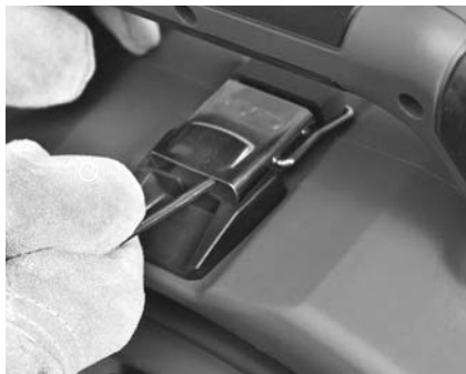
Obrázok 14 – Otvorenie západky pod držadlom (pomocou šesťhranného kľúča)
