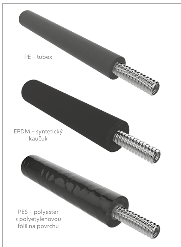
OBRÁZEK 14 – DRUHY TEPELNÝCH IZOLACÍ TRUBEK WR
