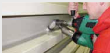
Úhlový adaptér 45° pro WELDPLAST S2 usnadňuje svařování v těžko dostupných místech.
