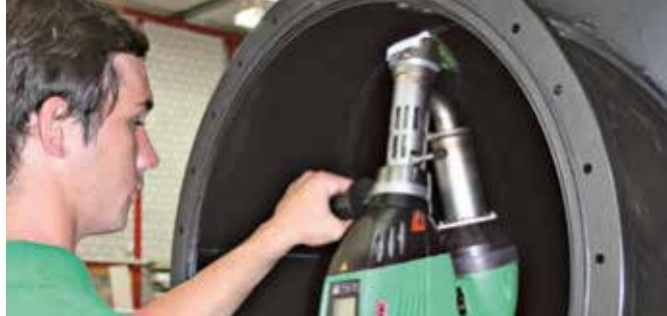
Snadno se svařují i vnitřní profily.
