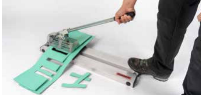
Vyřezání naprosto shodných testovacích vzorků.
