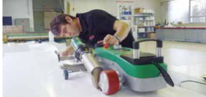
Souprava pro snadné svařování lemu se šnúrou, a nebo bez.
