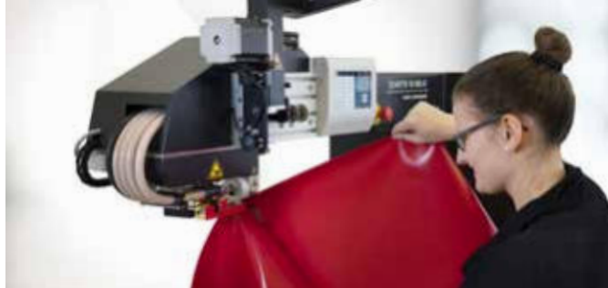
Svařování nízkonapětovým horkým klínem
