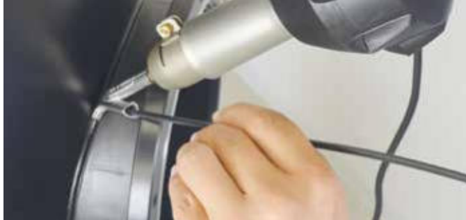
Svařování pomocí rychlosvařovací trysky
