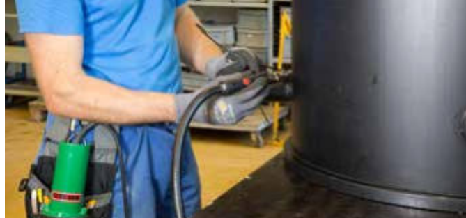
LABOR S, ve spojení s dmychadlem MINOR jako externím přívodem vzduchu.
