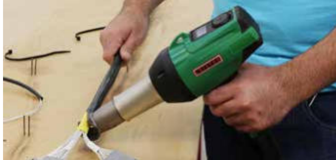
GHIBLI AW - ideální pro smršťování při výrobě kabelů.
