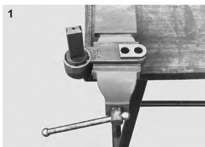
**deu** Biegerantrieb in Schraubstock sicher spannen und Spindel in Ausgangsstellung bringen.
