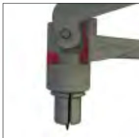
Technologie EPT - Vnitřní lomená páka
