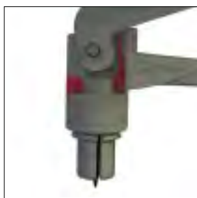
Technologie EPT® - vnitřní lomená páka
